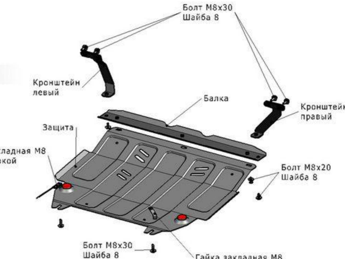
5. Заднюю часть защиты надеть на установленные болты M8x30, переднюю часть прекрепить к балке болтами M8x20.
